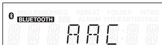
Le codec AAC est utilisé
